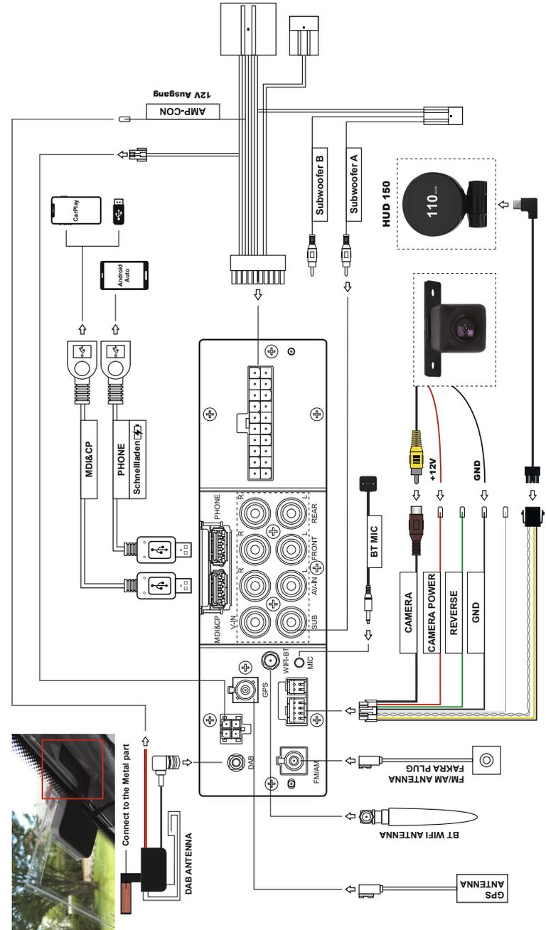
Schauen Sie bitte den folgenden Schaltplan für alle Zubehör und Kabelanschlüsse an. Bitte beachten Sie die Verkabelungs- und Installationshinweise für die DAB-Antenne.
