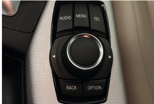
Drücken und halten Sie die **"BACK"**-Taste für 2 Sekunden, um zwischen dem originalen Menü und dem Dynavin-Menü zu wechseln.
