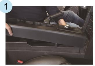
Schrauben entfernen und Armlehnensowie deren Schrauben entfernen
