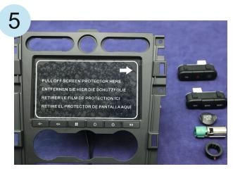
Original-Fahrzeugteilen auf Dynavin-Blende einsetzen
