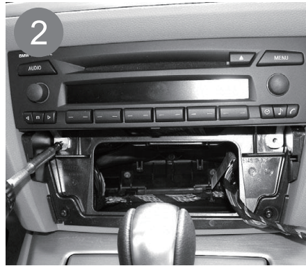
Entfernen Sie die zwei Kreuzschrauben an der Unterseite des Radios
