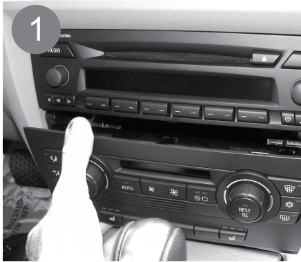
Das Klimabedienteil vorsichtig ausclipen und entnehmen
