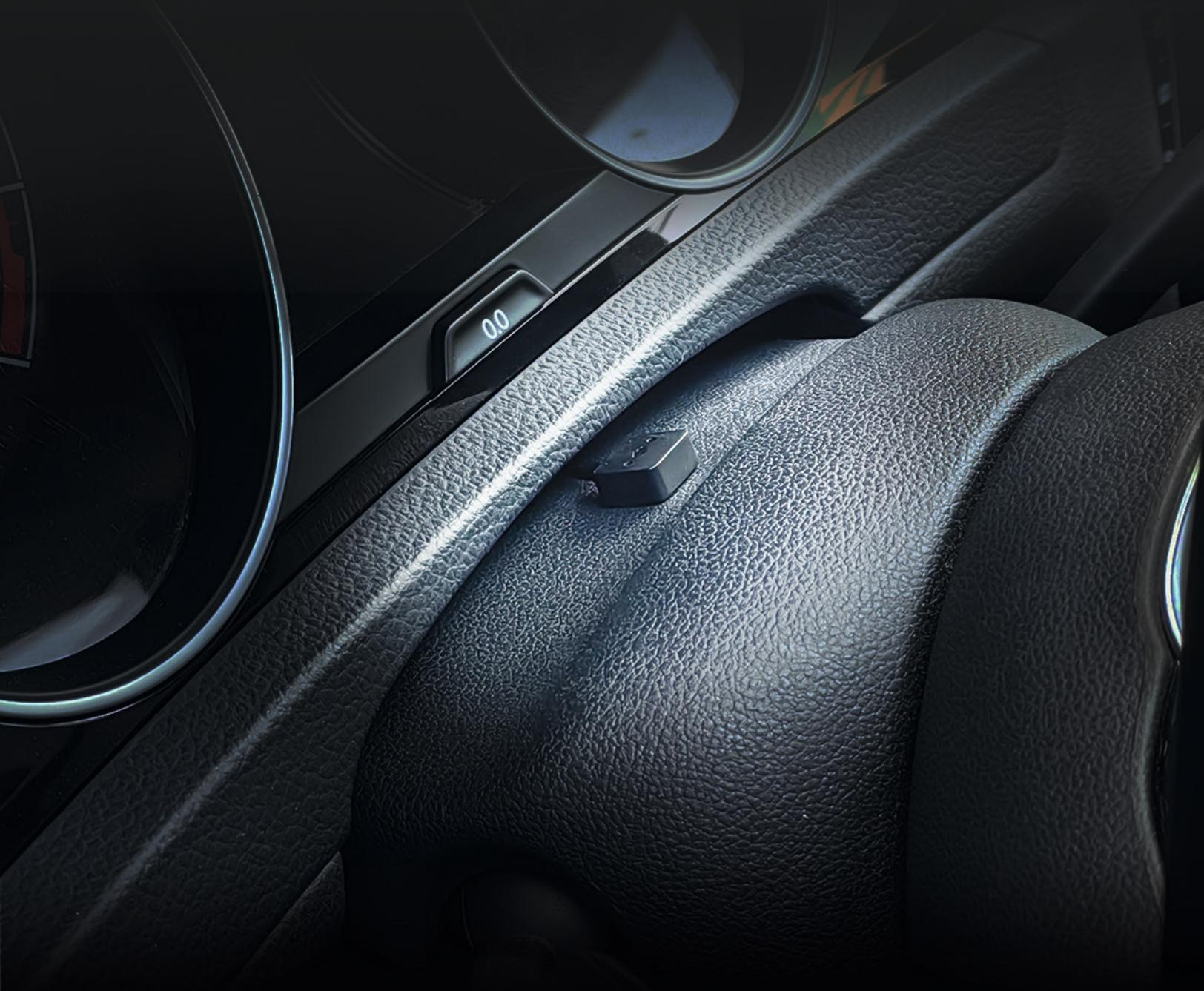
Das neue Dynavin Digital Kompakt-Dual-Mikrofon wird normalerweise vor dem Tacho angebracht. Dieses digitale Mikrofon ist klein und nach der Installation kaum bemerkbar. Im Vergleich zu OEM-Mikrofonen spart die Einrichtung dieses Dynavin-Mikrofons viel Installationszeit. Zudem sorgen die eingebauten Dual-Digital-Mikrofonchips für eine stabile und hervorragende Gesprächsqualität während der Fahrt.
